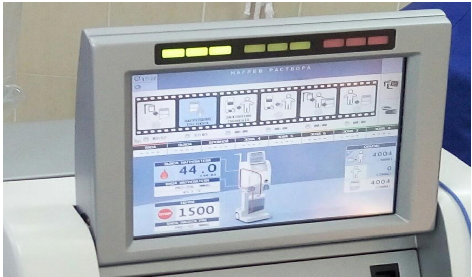
Рис. 1. Показники роботи системи: цільова температура – 44,0 С, об'єм – 1500,0 мл, II фаза роботи (із 6 –см. Лінійку в верхній частині монітора) – нагрів розчину
