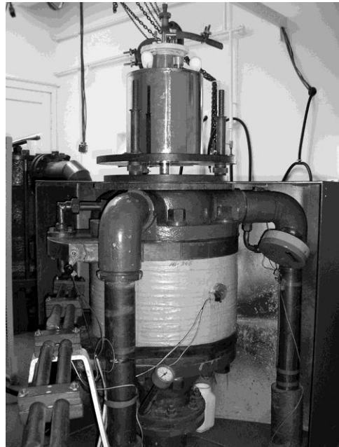
Рис. 2.18. Загальний вигляд установки на основі біттерівського магніту та гелієвого кріостату
