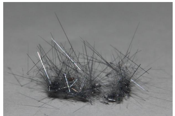
Рис. 2.4. Загальний вигляд пучка НК Si_{1-x}Ge_x
