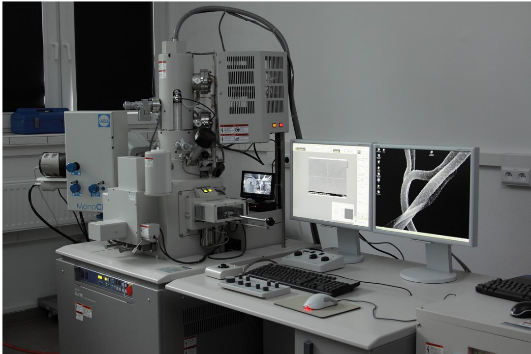
Рис. 2.8. Скануючий електронний мікроскоп з польовою емісією (типу Шоттки) фірми JEOL JSM-7600F, вбудований в рентгенівський спектрометр з дисперсією енергії INCA 250 фірми OXFORD
