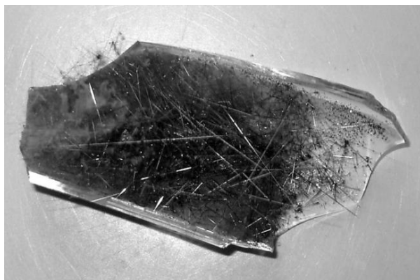
Рис. 2.3. Загальний вигляд ампули з НК Si_{1-x}Ge_x , вирощених в закритій бромідній системі методом хімічних газотранспортних реакцій
