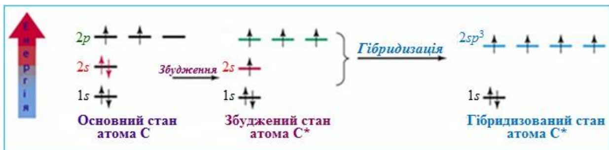
Рисунок 3. Схема послідовного переходу атома карбону в збуджений і гібридизований стан.
