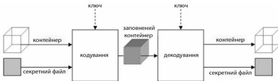
Рис. 2 Загальна схема процесу приховування інформації у цифровому зображенні
