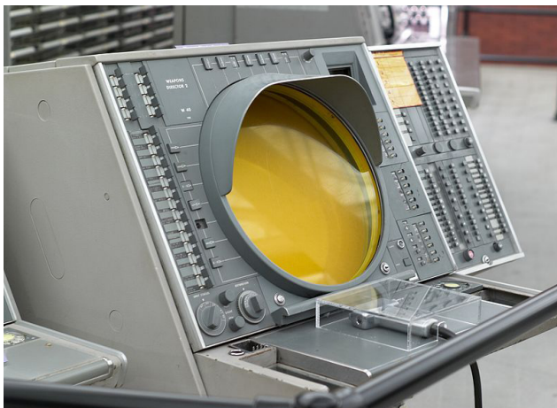
Мал. 5. Термінал оператора системи SAGE (Напівавтоматичне наземне середовище).
