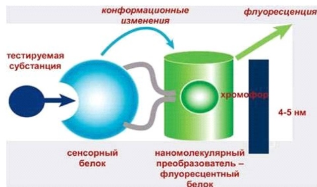
Рис. 3.1. Схема конструкції нанобіосенсора
