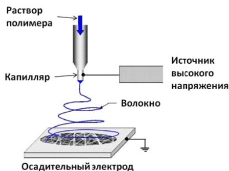
Рис.7.16. Схема установки для отримання волокон методом електроспінінга
