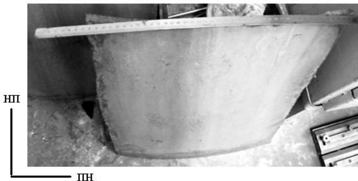
Рис. 2.3. Фрагмент зразка циліндричної форми зі сталі 09Г2С.
