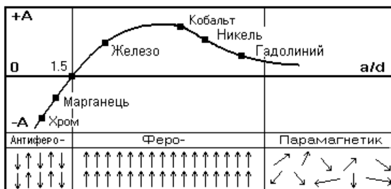
Рис. 1.1. Схематична залежність інтеграла обмінної енергії A від відношення міжatomної відстані a до діаметру незаповненої електронної оболонки d .
