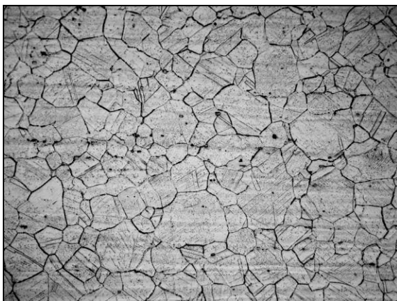
Рис. 4.3. Мікроструктура зразка зі сталі № 1. Знято на мікроскопі «Неофот-32». Збільшення \times 200 .
