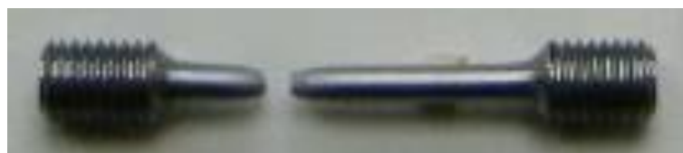
Рис. 2.4. Зразок після випробувань на одноосьвовий розтяг.
