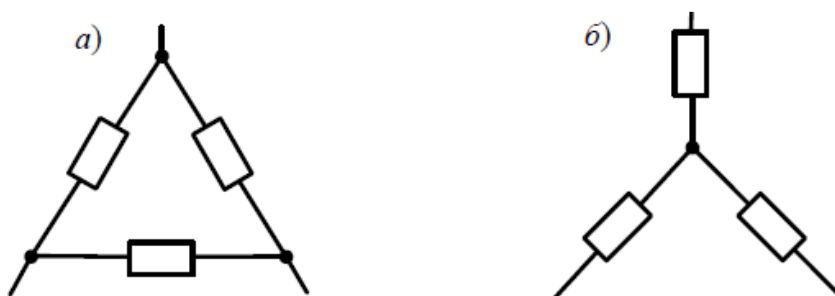
Рис.15. Схеми з'єднання резисторів трикутником (а) та зіркою (б)
