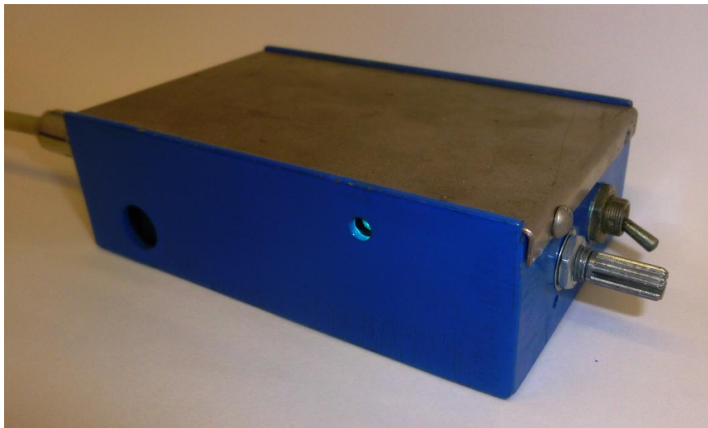
Рис. 2 (П 3 ). Підсилювальний блок для реєстрації сигналу термопар з компенсацією напруги опорного спаю
