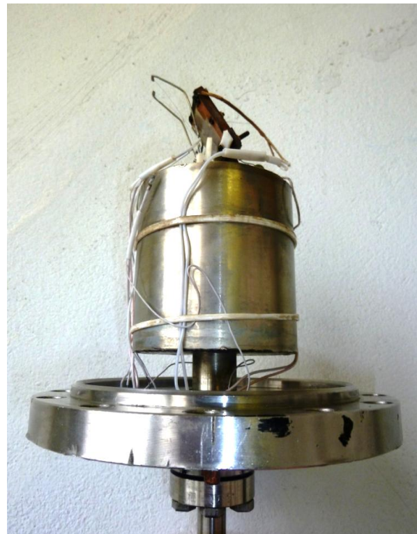
Рис. 2.4. Сенсор для визначення потоку атомів (на вакуумному фланці дослідницької установки)
