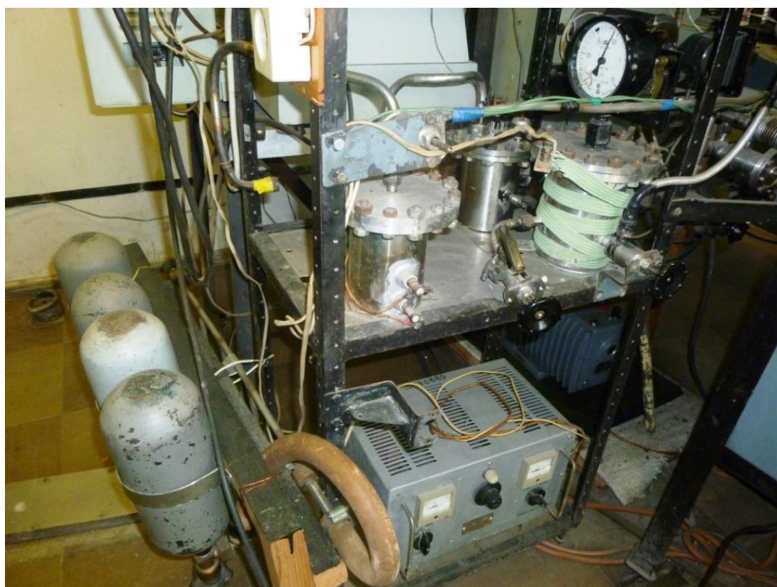
Рис. 4 (П 2 ). Система розподілу і напуску чистих газів
