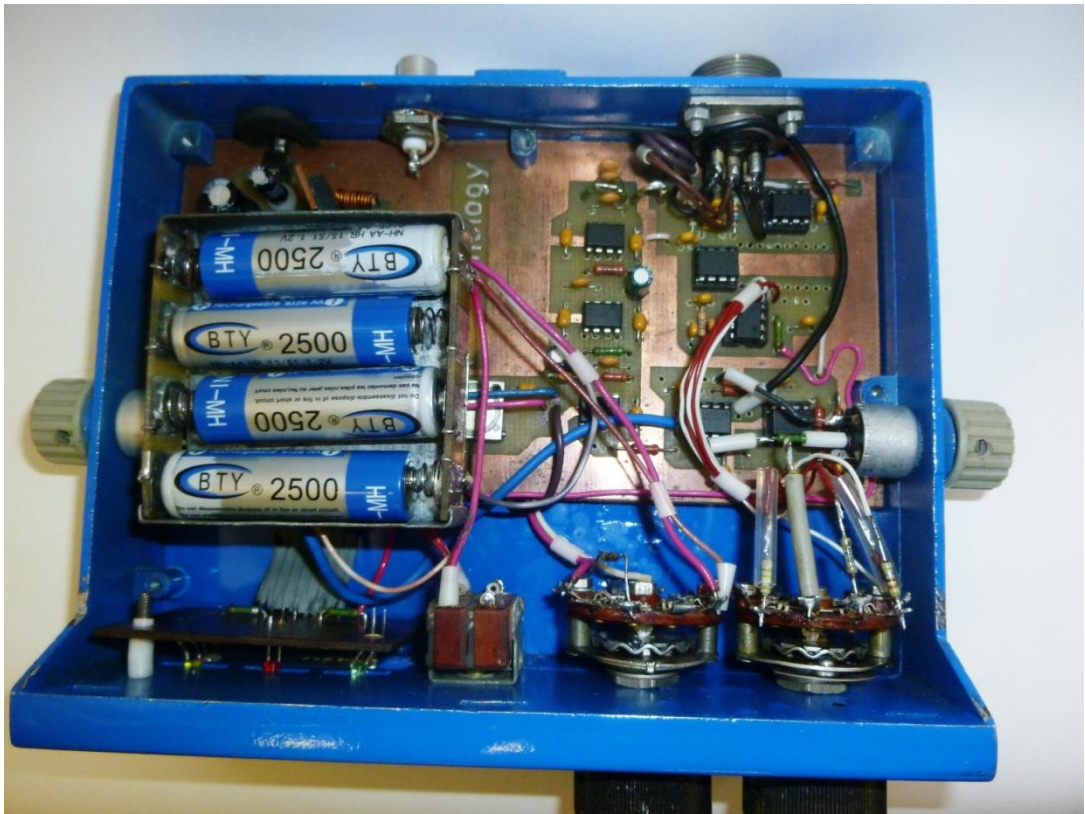
Рис. 3 (П 3 ). Внутрішній устрій інструментального підсилювального блоку
