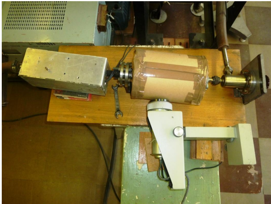
Рис. 1 (П 3 ). Приставка для визначення коефіцієнтів рекомбінації атомів \gamma і коефіцієнтів акомодатії \beta на досліджуваних зразках
