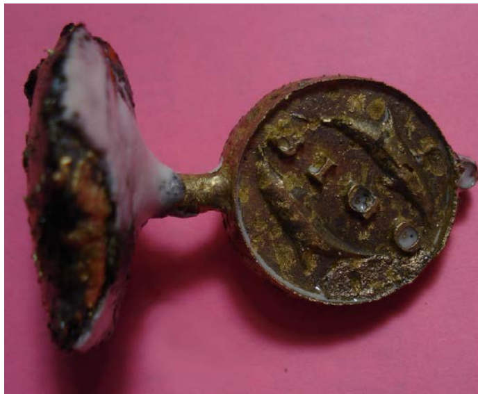
Рис. 4.10. Відливка брелока з ливником
