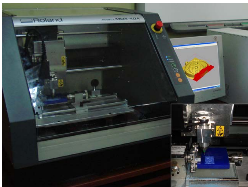
Рис. 4.8. Процес фрезерування брелока на верстаті Roland MDX - 40A
