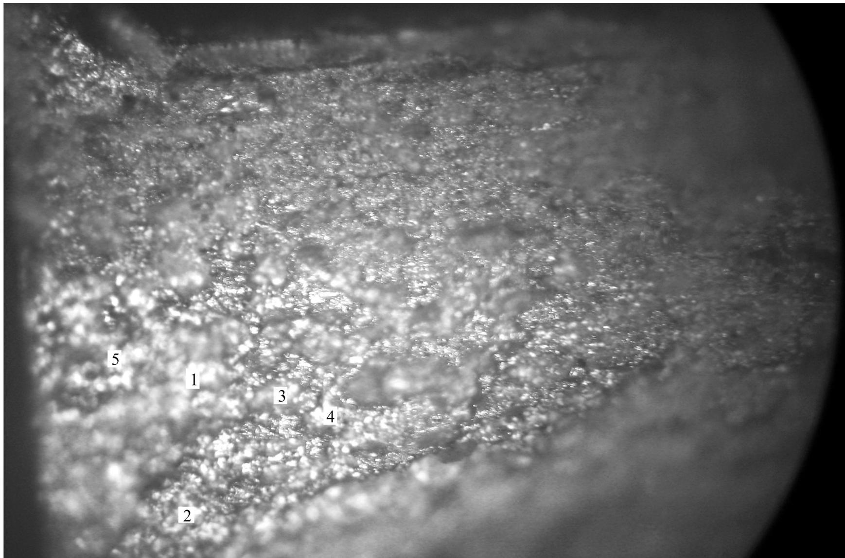
Рис. 3.17. Фото усталостного излома алюминия.
