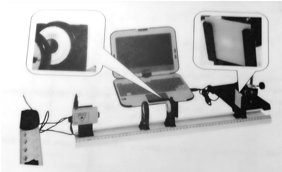
Рис. 2.3. Пристрій для спостереження інтерференції лазерного випромінювання на двох щілинах
