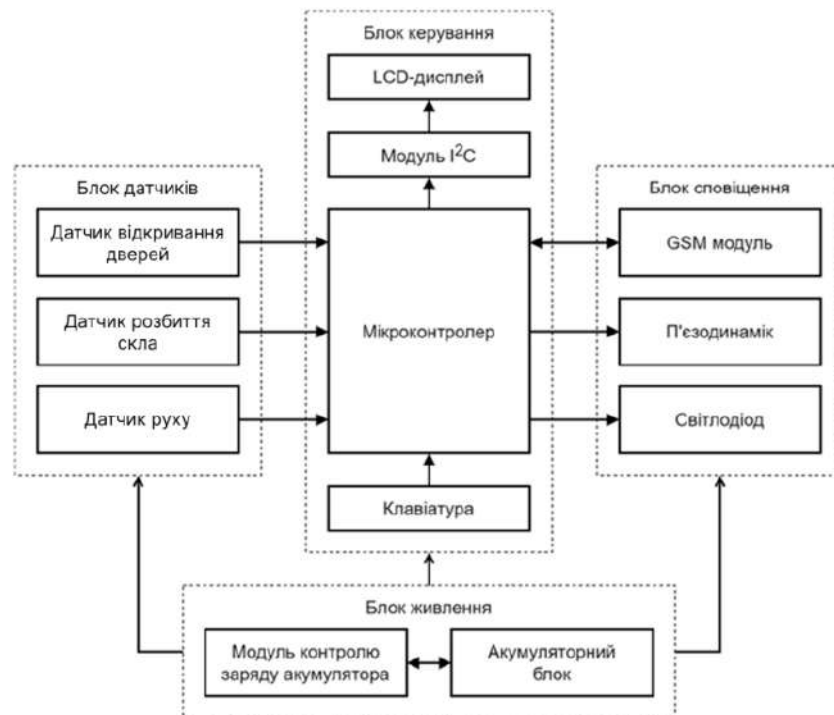
Рис. 1 – Структурна схема побутової охоронної системи
