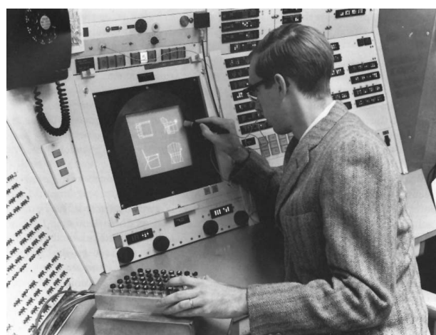
Мал. 12. Айвен Сазерленд демонструє роботу в програмі «Блокнот» (Sketchpad) в МТІ, 1963 рік.
