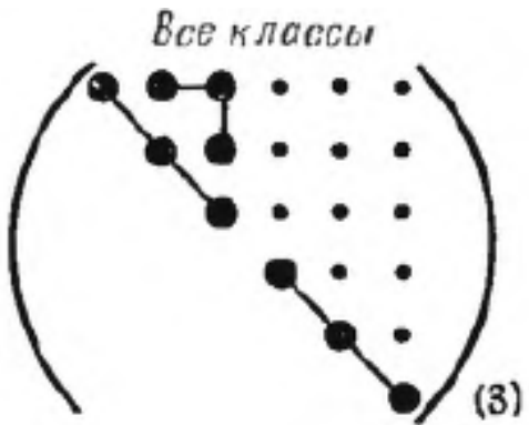
Рис. 2.28. Схема співвідношення компонентів матриці тензора податливості для кубічного кристала (3)-число незалежних компонент
