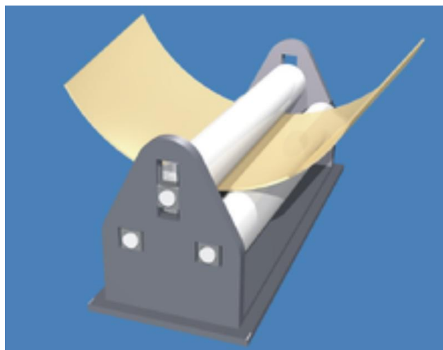
Рис.3.1. Установка для проведения изгибных деформаций листовых материалов
