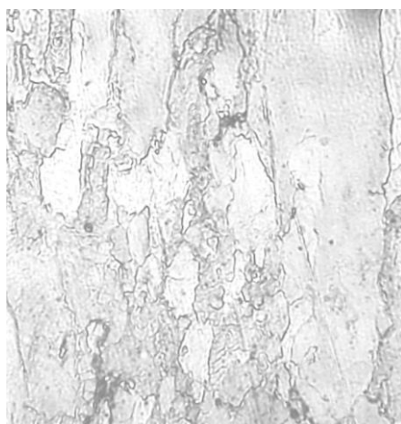
Рис. 3.29. Микроструктура промежуточного слоя на глубине 6,5 мм от поверхности листов стали 06Г2МТФБР после горячей прокатки с конечной температурой 720^{\circ}\text{C} . ( \times 400 )
