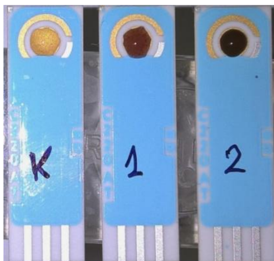
Рис. 4.15. Фотографія золотих планарних електродів модифікованих лакказою, без наночастинок золота (К) та з біо-наночастинками золота E-Au-НЧ1 (1) та E-Au-НЧ2 (2) іммобілізованих в уреасил-вмісному композиті ( As_2S_3 -ureasil) [130].
